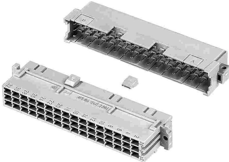
Den Kodierstift in die Federleiste nach Skizze einstecken. Die korrespondierende Ausnehmung am Messerleistenkragen ausbrechen. Die Steckverbinder mit Kodierung lassen sich im Raster 20,32 mm im Einschubrahmen montieren.
