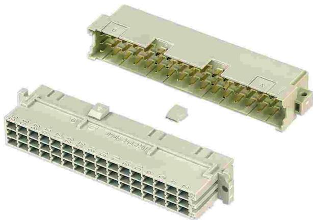
Zur Unverwechselbarkeit mehrerer Steckverbinder nebeneinander ist eine Kodierung erforderlich. Den Kodierstift 09 06 001 9919 in der Federleiste nach Skizze einstecken. Die korrespondierende Ausnehmung am Messerleistenkragen ausbrechen. Die Steckverbinder mit Kodierung lassen sich im Einschubrahmen im Raster  $\geq 20,32$  mm montieren.
