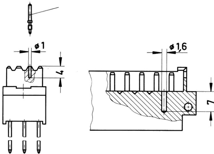
Zur Unverwechselbarkeit mehrerer Steckverbinder nebeneinander ist eine Kodierung erforderlich. Messerleiste an vorzentrierter Stelle nach Skizze aufbohren. In Federleiste Kodierstift 09 06 000 9950 mit Setzwerkzeug 09 99 000 0103 in vorhandene Bohrung einsetzen.
