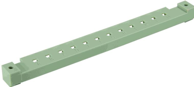
Zur Unverwechselbarkeit mehrerer Steckverbinder nebeneinander ist eine Kodierung erforderlich. Die Kodierung ist sowohl an der Messer- wie auch an den Federleiste fest angebracht. Die 12 Kodierstifte (Artikelnummer 09 02 000 9928) ermöglichen über 900 Kodiermöglichkeiten. Diese Stifte werden in das Steckverbinderoberteil und -unterteil eingerastet.
