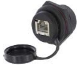
**Steckverbändertyp Anschluss 1+2:** Buchse RJ45 Cat.6 Klasse E (bis 500 MHz, geeignet für 10 GBit und Power over Ethernet)
