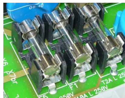
Abbildung 3: Sicherungen im Halter montiert und so nahe platziert wie abgebildet, können sich gegenseitig bezüglich der Temperatur beeinflussen
