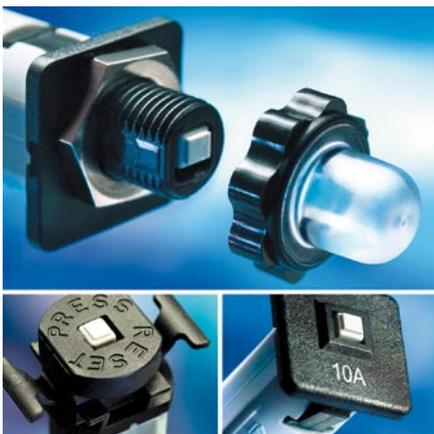
Thermische Geräteschutzschalter haben den Vorteil, dass sie unempfindlich gegen Einschalt-Stromspitzen sind, wie sie beim Starten von Transformatoren oder Motoren entstehen. Dennoch ist für die Dimensionierung des Nennstromes nicht nur der Nennstrom der Last massgebend. Weitere Parameter wie Einschaltstrom, Überlastkapazität, Betriebsart und Umgebungstemperatur sind dabei zu berücksichtigen.
