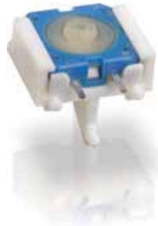
→ Die Ausführung RACON 12 V kann u.a. für PC-Einschubkarten und in der Mess- und Regeltechnik eingesetzt werden. Der Abstützwinkel nimmt dabei die Betätigungskräfte auf, so dass die gelöteten Anschlüsse entlastet sind. Für diese Befestigungsart ist der Taster mit zwei seitlichen, waagrechten Anschlüssen versehen.
