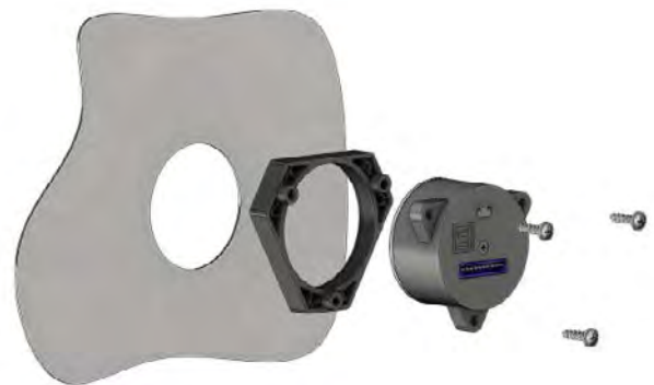
Montage des Design-In Kit mit Montagering
