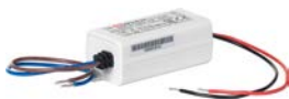
Netzteil Schaltnetzteil IP42 für LED- und Beleuchtungsanwendungen im Innenbereich 90–264 VAC => 24 VDC 0.34 A 8 W
